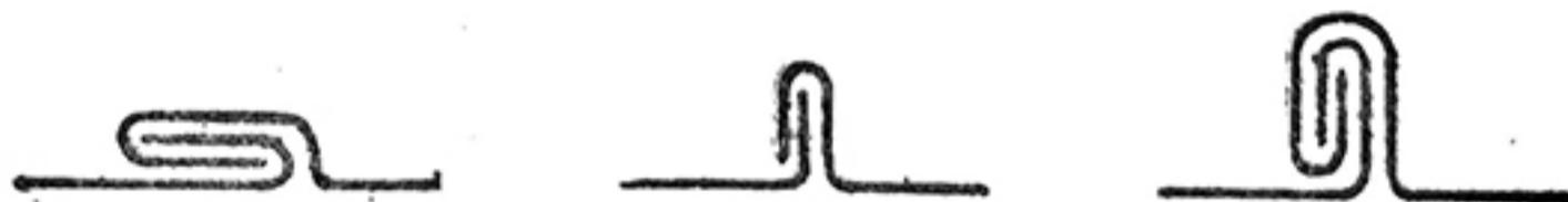
Unión por endentadura especialmente para chapa de cobre. La chapa de cobre se suelda con bronce granulado (soldadura fuerte)
